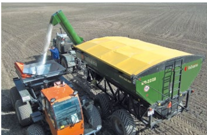
Загрузка разбрасывателя удобрений с помощью бункера-перегрузчика «Лилиани»
