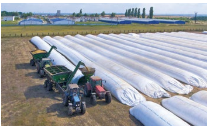
Бункер-перегрузчик «Лилиани» на загрузке зерноупаковочной машины МЗУ.
