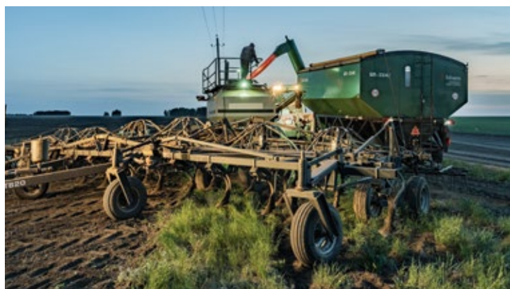
Загрузка посевного комплекса с помощью бункера-перегрузчика «Лилиани».
