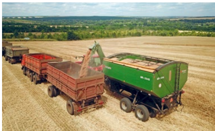
Бункер-перегрузчик «Лилиани». Выгрузка в автомашину.
