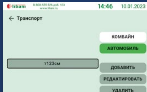
Автоматическое добавление транспорта по RFID с возможностью ручной корректировки данных.
